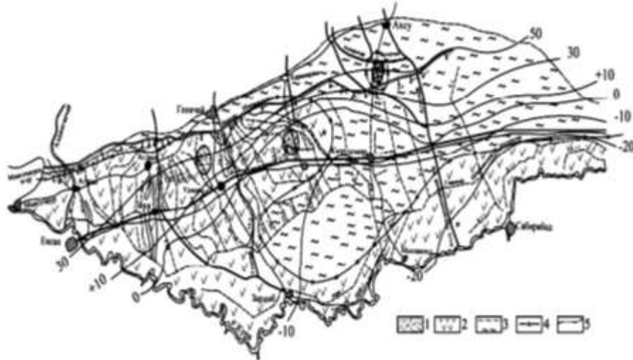
Şəkil. 1. Şirvan düzənliyinin hidroizohipslərinin və yeraltı suların səviyyəsi dərinliklərinin sxematik xəritəsi (20 may 1950-ci il, tərtib edən Ç. D. Gülməmmədov). Nişanlar: yeraltı suların səviyyəsi: 1) 2,5 - 3,0 m; 2) 3,0 - 5,0; 3) 5,0 m-dən çox; 4) yeraltı suların müxtəlif dərinliklərinə malik olan sahələrin sərhədləri; 5) hidroizogips xətləri [2,s 44].
